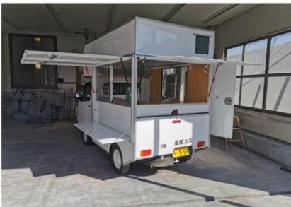
軽トラックの荷台寸法ギリギリまで広げたキッチンスペース。ボックスタイプではなく床から作りあげ、屋根が外れる高級タイプです。
