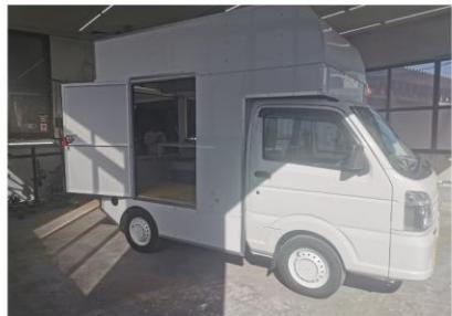
乗り込み口も幅90cm、高さ130cmと大きくなりました。人の乗り降り荷物の出し入れなどをより簡単に行う事が出来るようになりました。ウエザーストリップの採用により隙間風や雨対策の強化も実施、ドアハンドルなどの改良により確実性もアップしました
